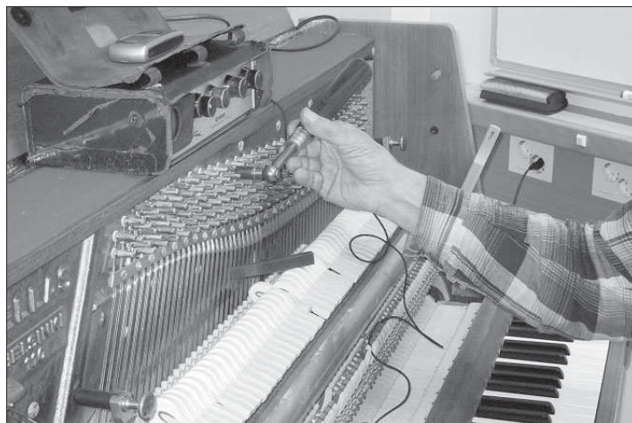
Allt skall stämma. Med en gummikil dämpar Ragnar de närliggande strängarna. Till sin hjälp har han också en stämnyckel.
