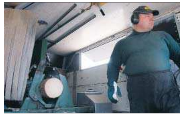
Skräddarsytt håll. Maskinen borrar ett lagom stort hål för öppningen och gröper sedan ur kubben. Hålet är anpassat efter fågelns storlek, beroende på om holken ska rikta sig till ugglor, starar eller talloxar.
