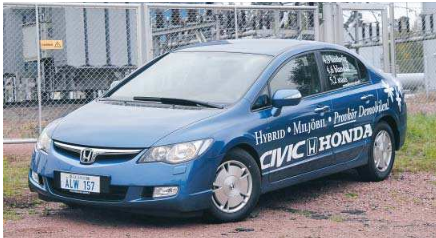
Delvis elkraft. Hybridbilarna drivs av både en elmotor och en bensinmotor. Honda har tagit fram en Civic med hybriddrift. Systemet fungerar med automatisk uppladdning av batterierna som driver elmotorn. Snart kommer också hybridbilar med elmotor och snål dieselmotor ut på marknaden. Foto: STEFAN ÖHBERG
