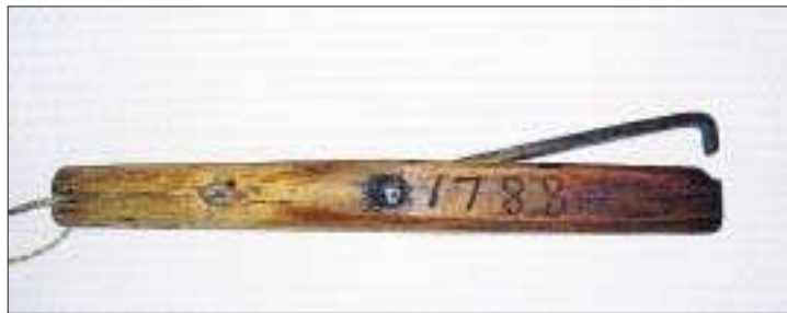
Bandhake för att dra banden över laggbåren så att det höll ihop och var tätt. Foto: PRIVAT
