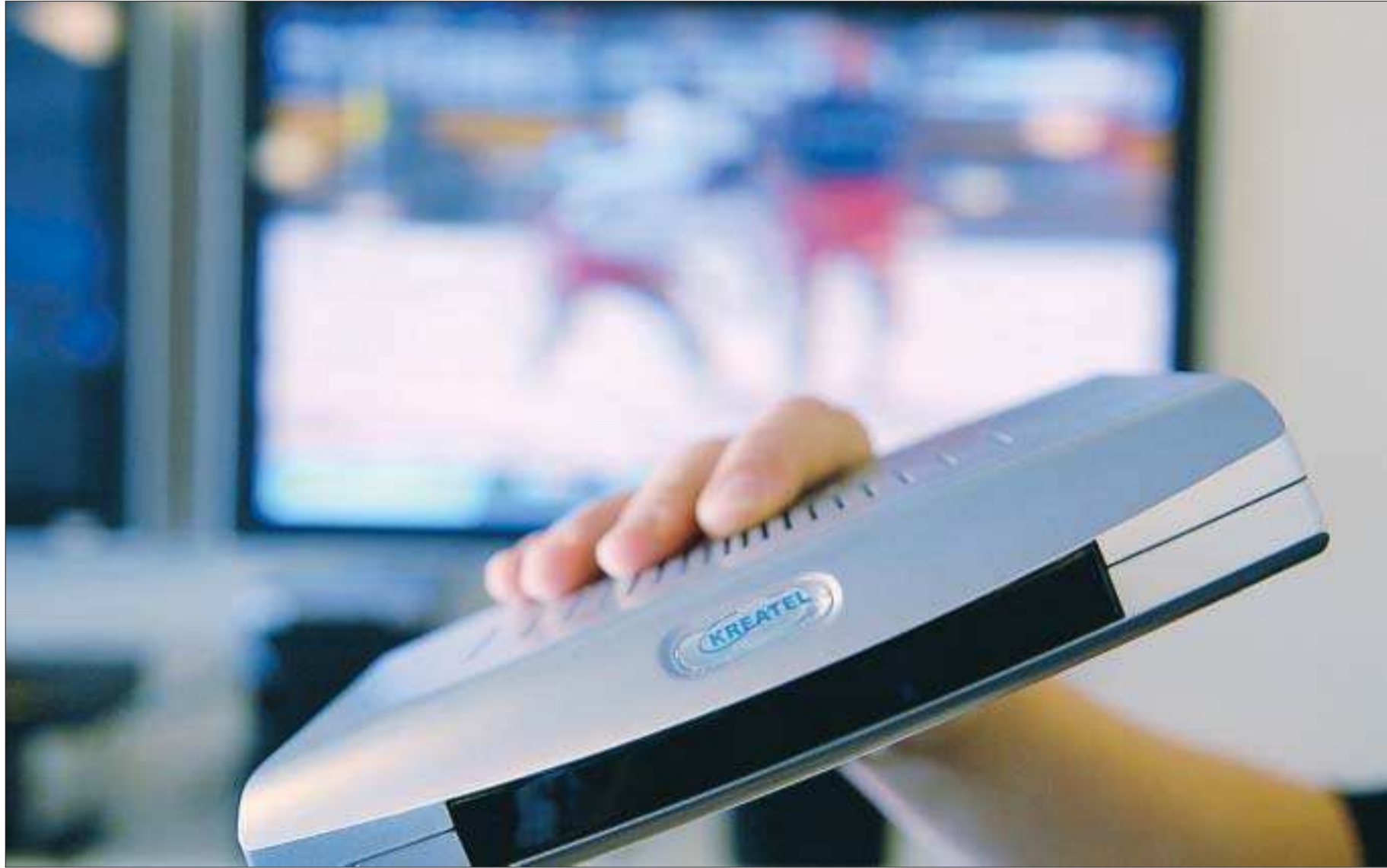
IPTV-box. IPTV är liksom kabeltv ett sätt att ansluta sig till tv-nätet. Digitaltv över internet skiljer sig dock från digitaltv över det marksända nätet och kabeltv-nätet. Du måste därför ha en skild digitalbox som passar för detta nät. Foto: JONAS EDSVIK
