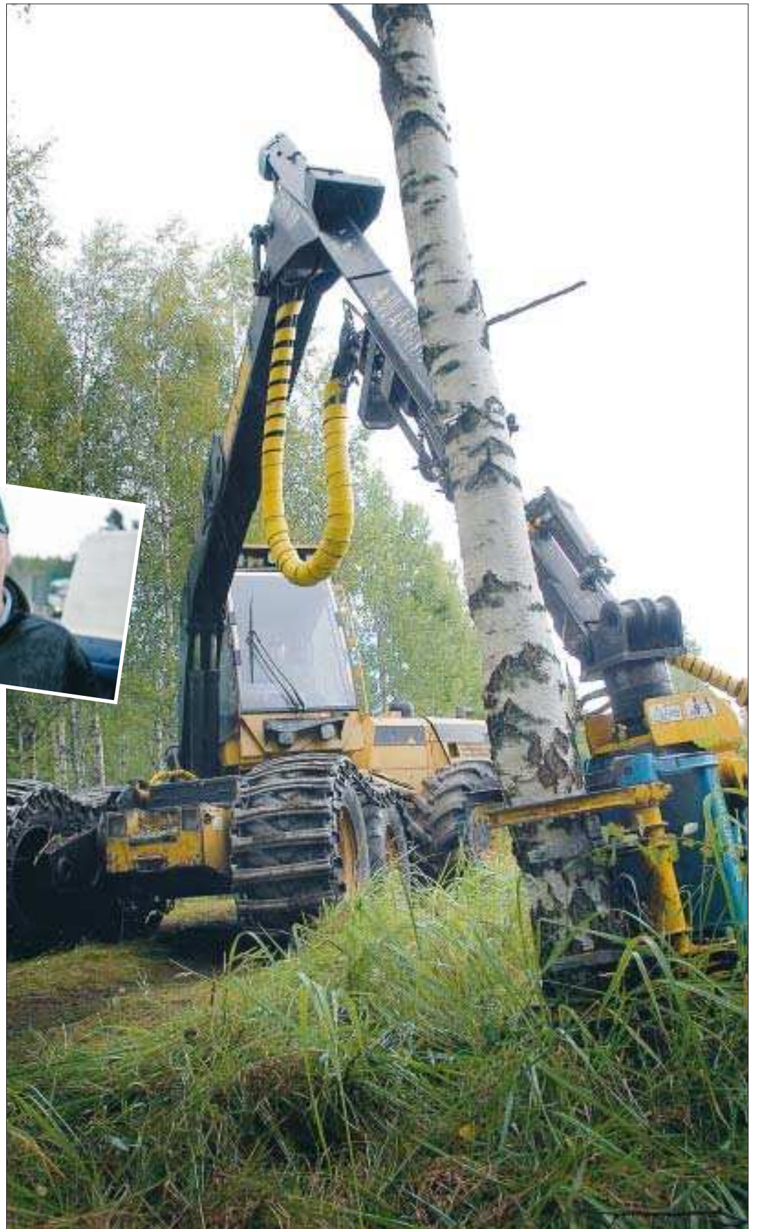
Mycket jobb. Lukas Lundström demonstrerar en skördare med klippaggregat, en maskin som funnits cirka två år på Åland. – Den är bra eftersom den kan användas i skog som är för liten för att gallra men för grov för att röja, säger han, och berättar att maskinen används flitigt hela sommaren.
