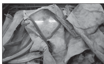
Skall fixas. Kapelltyget är i dåligt skick, men det går att reparera.
