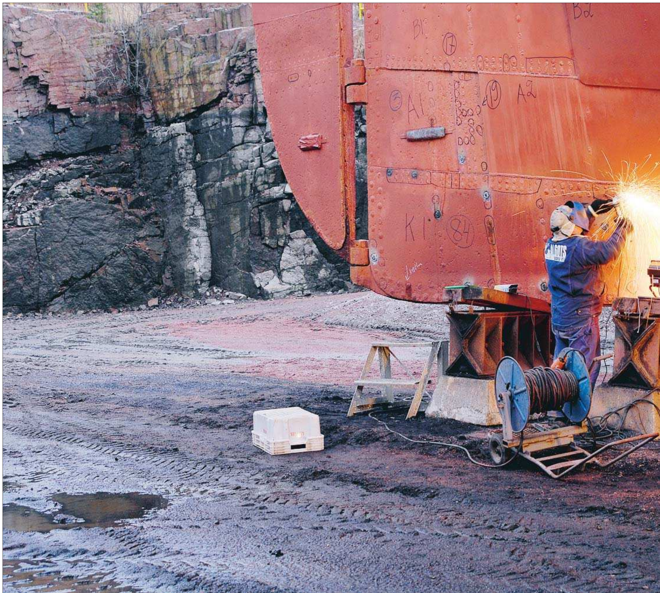
Åldrande dam. Museifartyget Pommern är i dåligt skick under vattenlinjen, något som syntes tydligt när hon renblästrats. Här förbereder Esa Nevalainen det omfattande arbete som ska utföras på fartyget i
