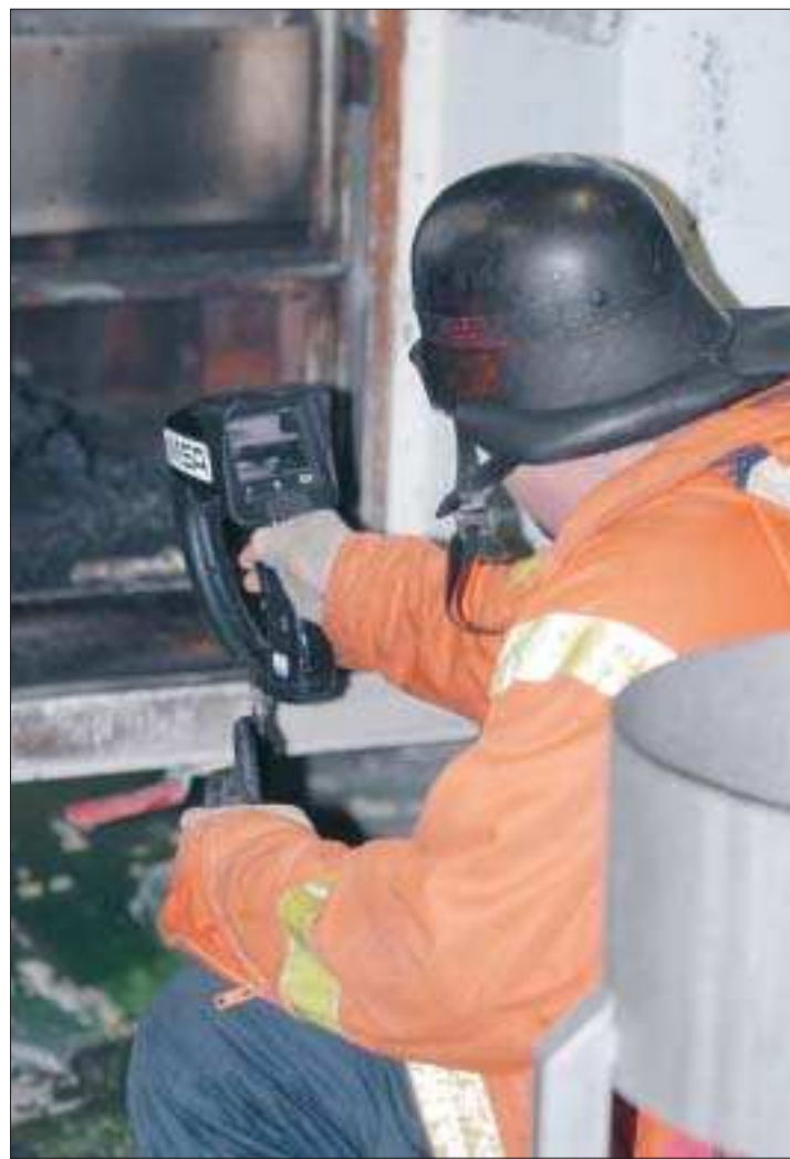
Värmemätare. En brandkårist mäter temperaturen i fläkten på taket.
