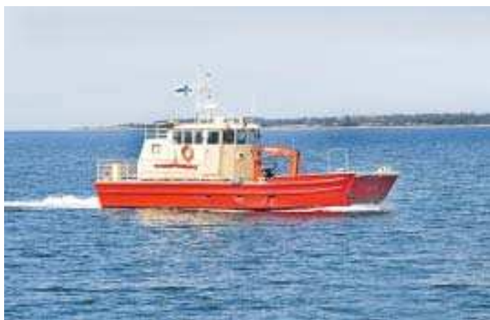
God fart. Farledsbåten har beteckningen MKL 2304. Två vattenjetmotorer ger en fart på cirka 20 knop.
