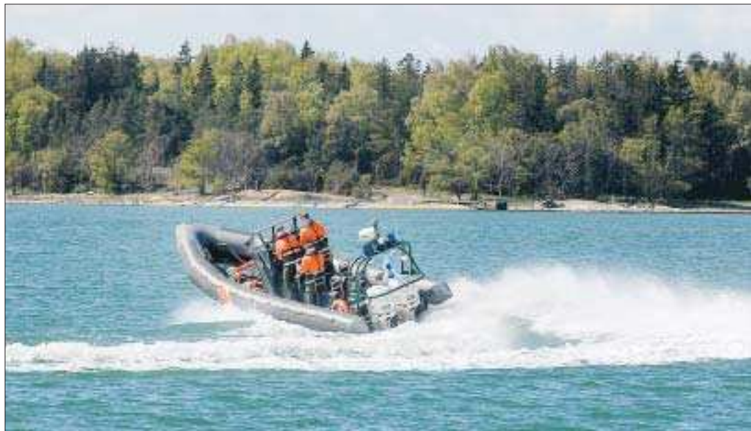
Snabbgående. Sjöbevakningens ribbåt går drygt 40 knop och har två motorer på 225 hästkrafter vardera.
