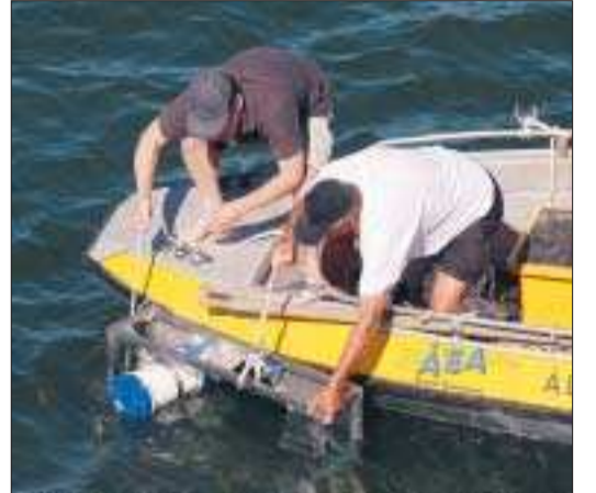
Mäter vattenströmmar. Stig Mattsson och Staffan Lundin sänker ned mätutrustningen vid Marsundsbron.
