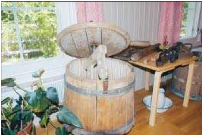
Välbevarad. En tvättmaskin som drivs med handkraft. Den är mycket välbevarad.
