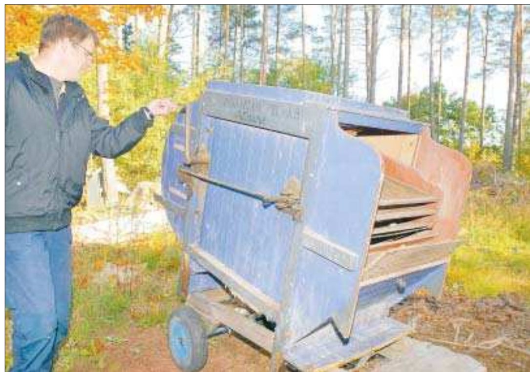
Med handkraft. Efter tröskningen finns ofta rätt mycket ogräsfrö med i säckarna. Det sorteras ut med hjälp av ett handdrivet rensverk.
