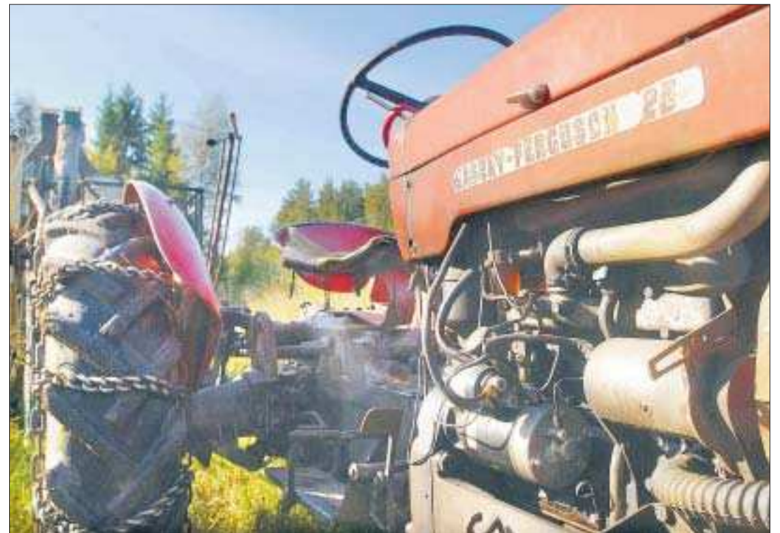
I aktiv tjänst. Tillräckligt stark men egentligen lite för lätt för att dra tröskan är Massey Ferguson-maskinen. Därför har hjulen försetts med snökedjor för att inte slira när det är vått i marken.
