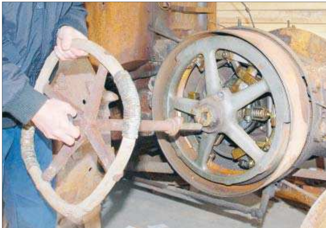
Ännu äldre. I uthusen på gården Fridhem finns många pärlor från förr. Här är originalratten till en traktor från 1953. Träratten tas loss från styrplatsen och används för att starta kultändarmotorn.
