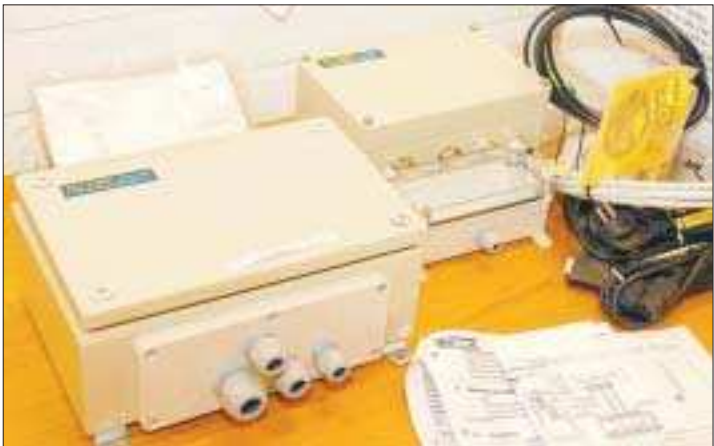
Låda. Så här ser enheten ut som rymmer elektronik och program. Innehållet plockas ihop i Mariehamn. Enheten placeras på ett utvalt ställe i fartyget och mäter dess rörelser för säkraste och mest ekonomiska drift och manövrering.
