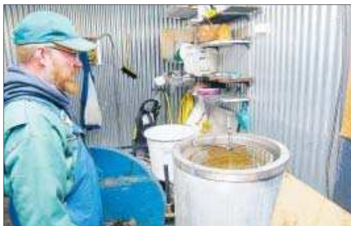
Pastöriserar. I en gryta med 80-gradigt vatten pastöriseras äppelmusten som rinner genom ett långt rör.
