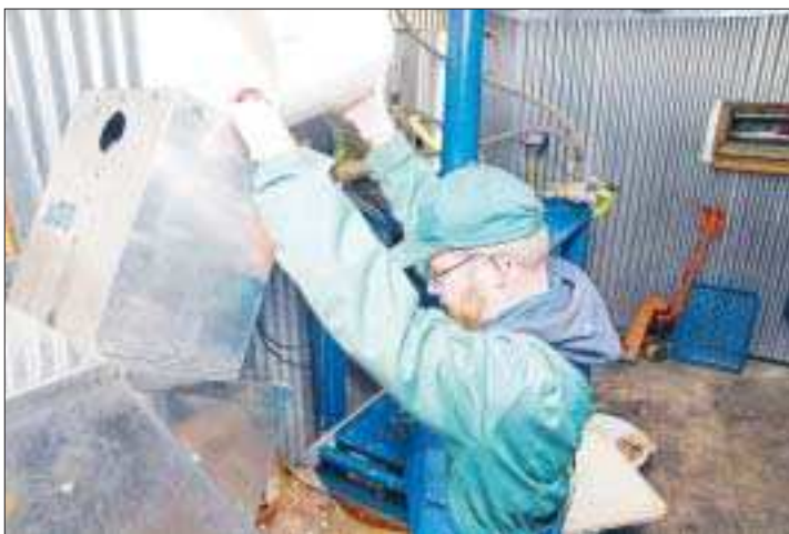
Kvarn. Äpplena hålls i kvarnen som tidigare tjänat ombord på Diana II som matavfallskvarn i köket. På nolltid mals frukten till mos.
