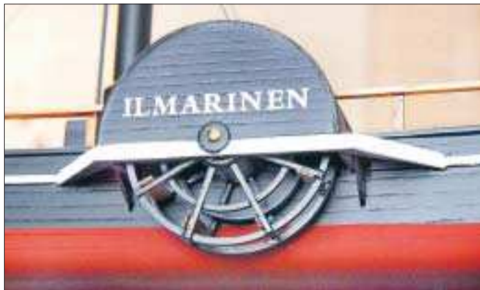
Hjulångare. Ilmarinen var en hjulångare och drevs fram av två skovelhjul placerade midskepps.
