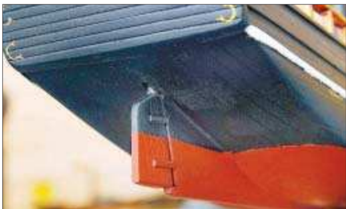
Roder. Ilmarinens roder manövrerades inte med ratt utan stod i direktförbindelse med en rorkult uppe på däck.
