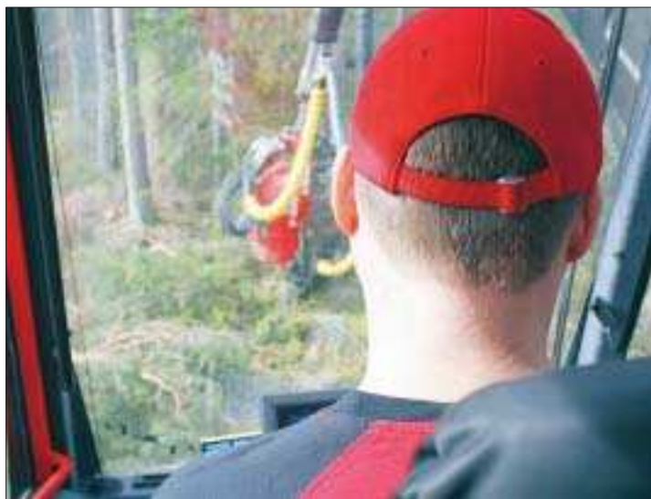
Datormåttad kapning. Robert Järvinen menar att det tar tre till fem år innan man lär sig köra en skördare, maskinen som avverkar träd, helt prickfritt. Dessutom måste man vara bra på aptering. Alltså att lära sig bedöma vad det man hugger ner ska användas till, om det är bra nog till virke eller om det bara duger som massaved till papper eller flis. Datorn i hytten hjälper även bland annat till med att mäta avståndet mellan kapningarna och kontrollera tjockleken på stocken.
