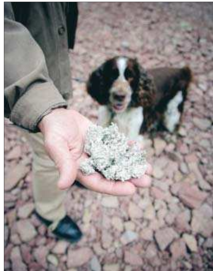
Cellulosa i väggar och tak. Istället för vanlig isolering fyller man ekohusets väggar och tak med pappersmassa.
