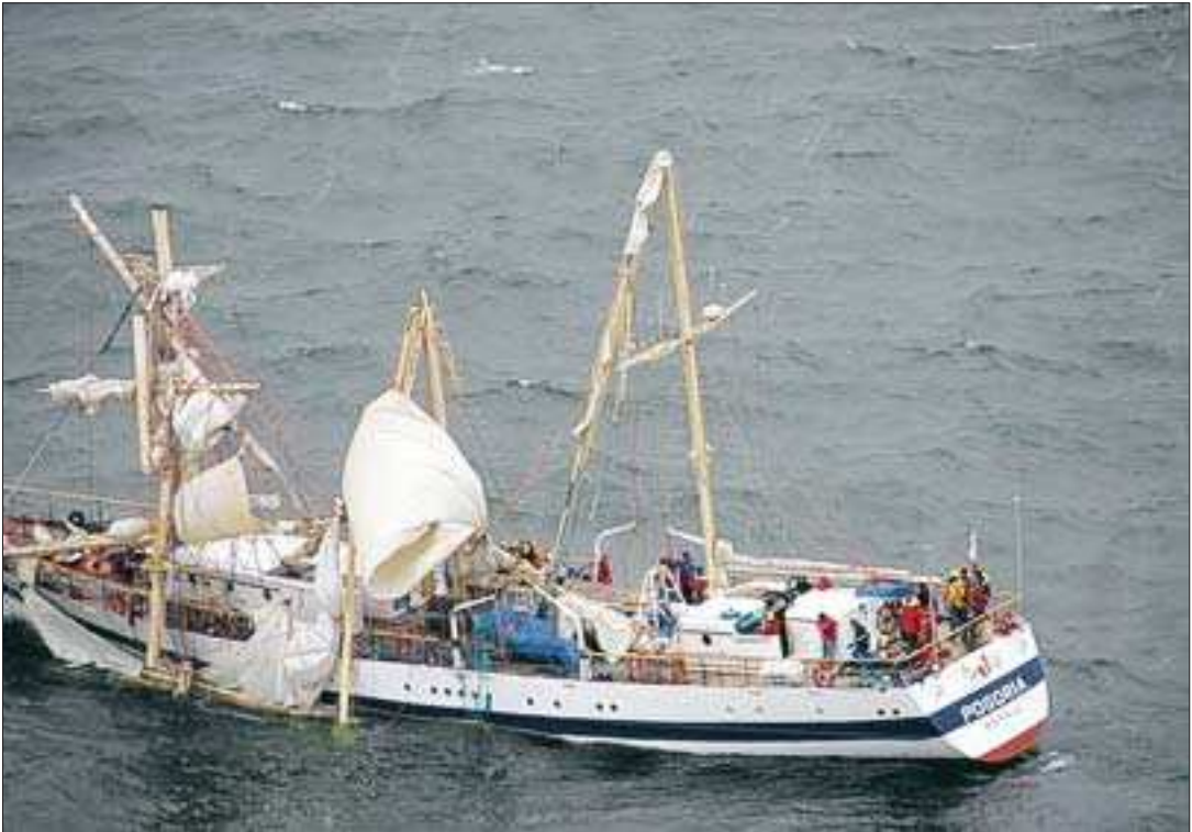
Haveri. Tall Ships Race-deltagaren Pogorias alla tre master knäcktes under den första etappen mellan Gdynia och St. Petersburg. Foto: SJÖBEVAKNINGEN
