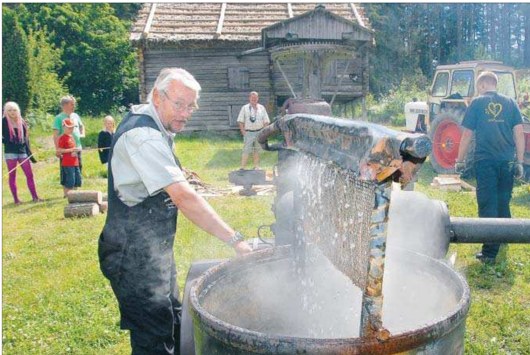
Märkvärdig maskin. "Den körs på diesel men går väl egentligen på nästan vad som helst" säger Tage Andersson om den gamla kultändaren som används vid pärthyvlingen.
