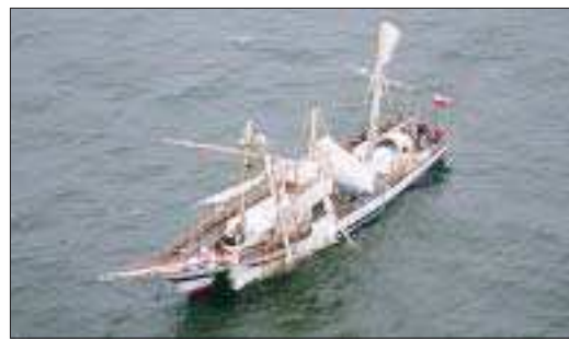
Det polska skeppet Pogoria fick trippel mastbrott under Tall Ships Race första etapp. Foto: SJÖBEVAKNINGEN
