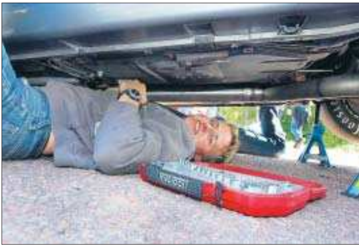
Teknikstrul. Conny Isaksson som tävlande i Rear Tech fick problem med ett trasigt stödlager och fick hoppa av tävlingen vid första elimineringsrundan.
