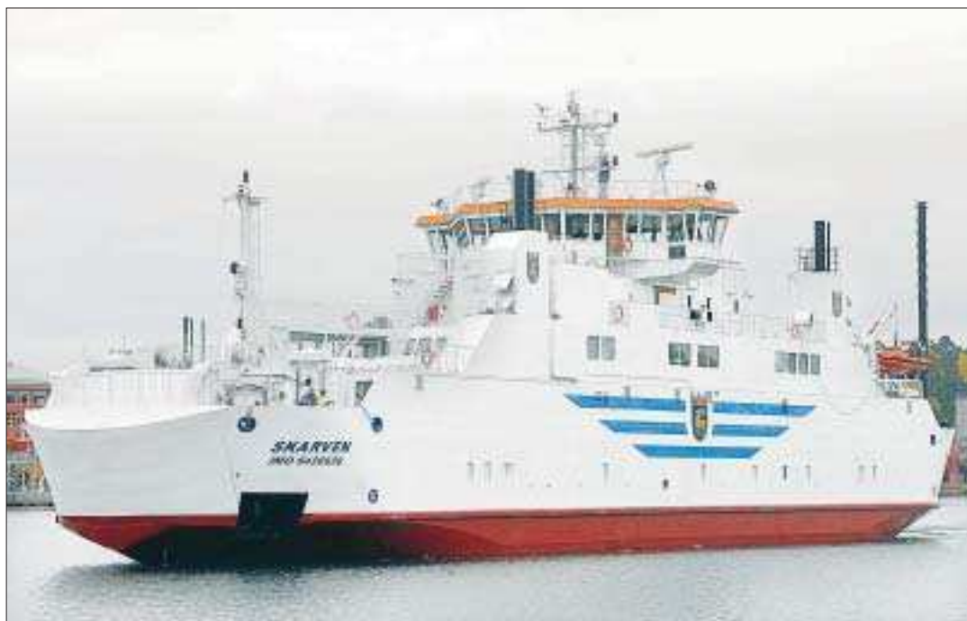
Nuvarande version. Efter att kontraktet med varvet i Litauen var undertecknat bestämdes det att Skarven skulle få ett slutet bildäck, ett beslut som sannolikt har påverkat fartygets vikt. Foto: ERKKI SANTAMALA
