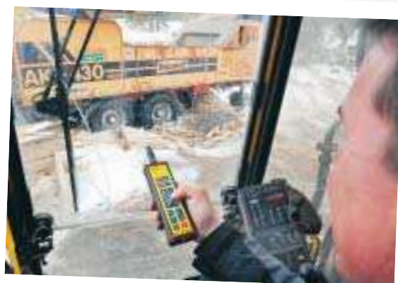
Maskiner. Bengt Karlssons jobb går till stor del ut på att fixa med olika maskiner. Från grävmaskinens hytt kan han smidigt reglera flistuggen med en fjärrkontroll.
