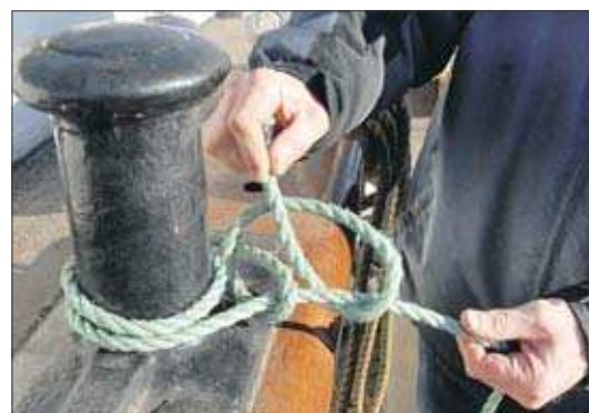
Lär ut knopar. Börje Åhlund är riggare på Pommern och en mästare på knopar. Här visar han en av de enklaste: råbandsknopen, även kallad sjömansknop.
