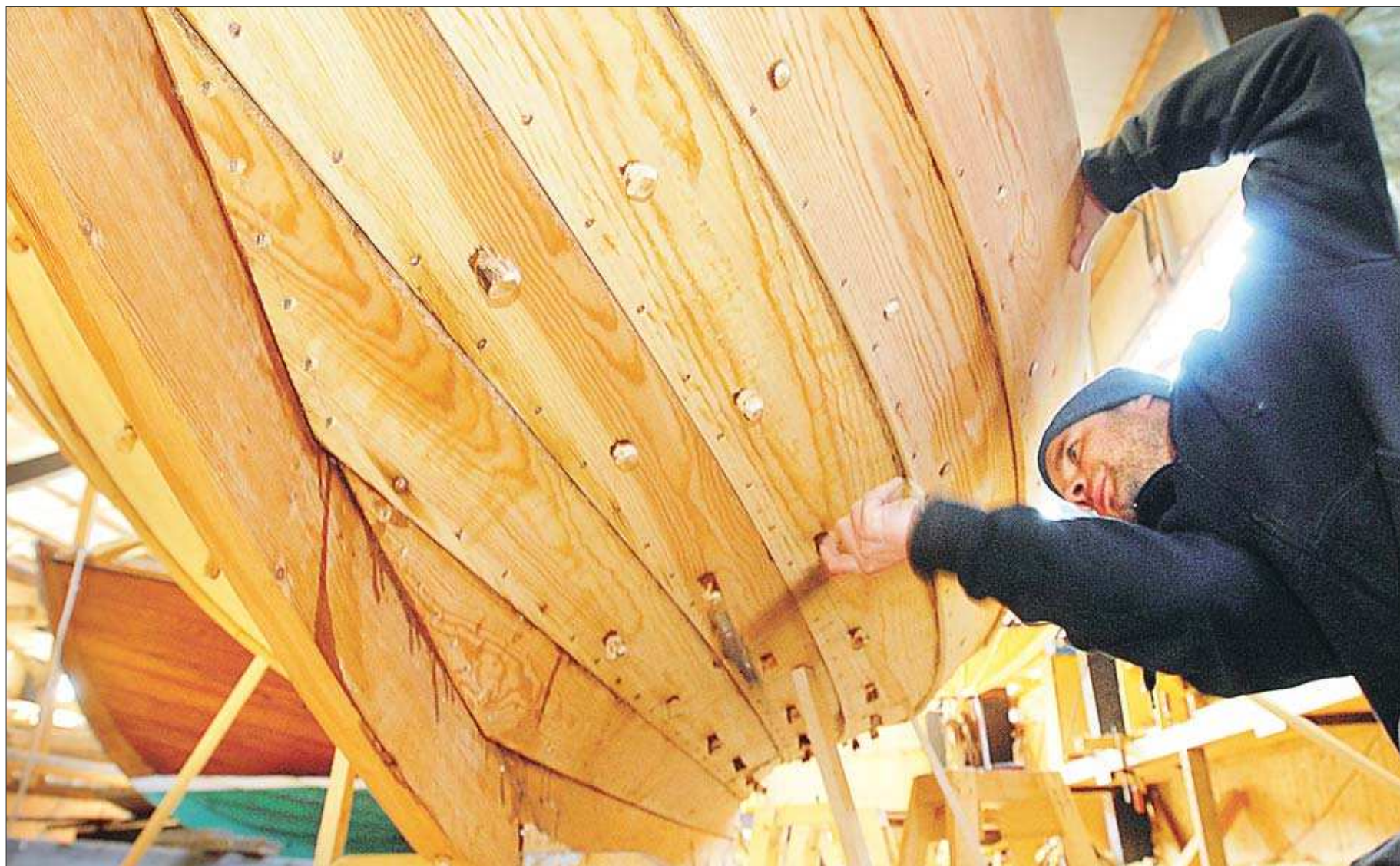
Båtbyggare. Petter Mellberg i arbete i Sjökvarteret. Här visar han hur han fäster borden vid spanterna med naglar av enträ.
