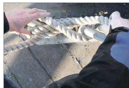
Skotstek. Börje Åhlund säger att det är viktigt att ändarna hamnar på samma sida för att det blir lättare att lösa upp knopen då. Det finns dock dom som hävdar motsatsen. Skotsteken används för att knyta ihop två rep.
