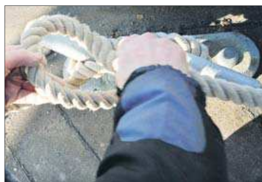
Att fästa vid en knap. En knap är ett beslag i form av ett T. Lägg linan i åttor runt skänklarna. Lås med ett halvslag.
