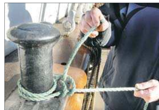
Lär ut knopar. Börje Åhlund är riggare på Pommern och en mästare på knopar. Här visar han en av de enklaste: råbandsknopen, även kallad sjömansknop.
