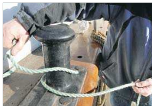
Dubbelt halvslag om egen part. Användbar när du vill fästa i en ring eller kring en pållare.
