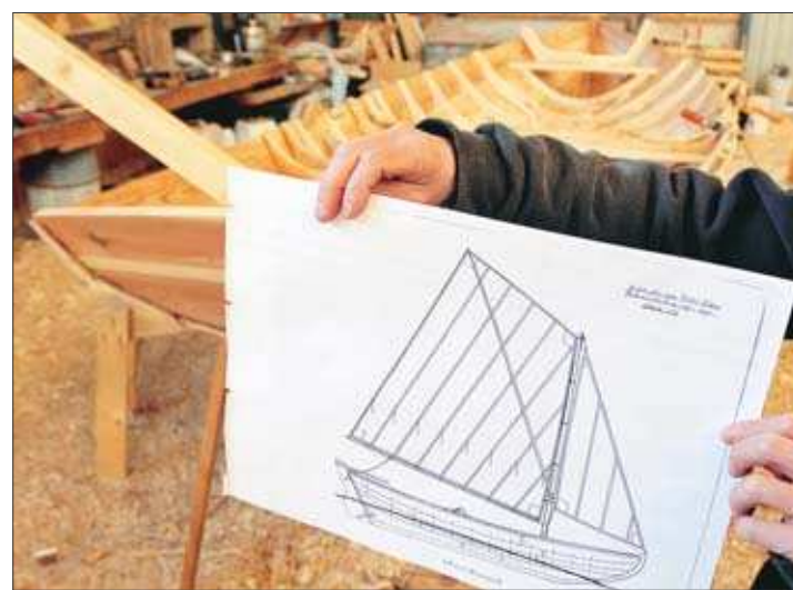
Segelritning. Jullan skall få sprisegel med fock.
