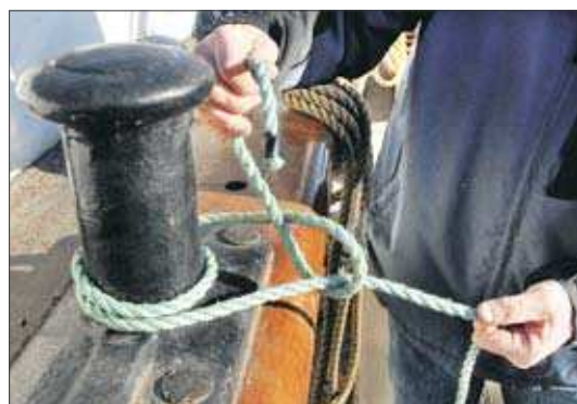
Dubbelt halvslag om egen part. Användbar när du vill fästa i en ring eller kring en pållare.
