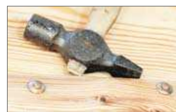
Borden är fästa vid varandra med båtspik av koppar.
