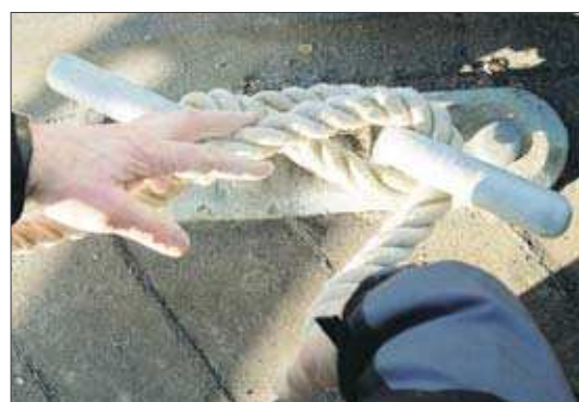
Att fästa vid en knap. En knap är ett beslag i form av ett T. Lägg linan i åttor runt skänklarna. Lås med ett halvslag.
