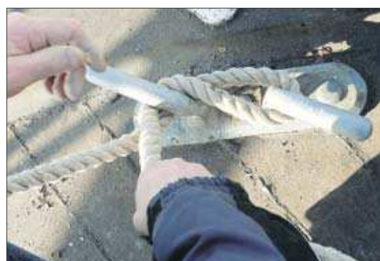
Att fästa vid en knap. En knap är ett beslag i form av ett T. Lägg linan i åttor runt skänklarna. Lås med ett halvslag.
