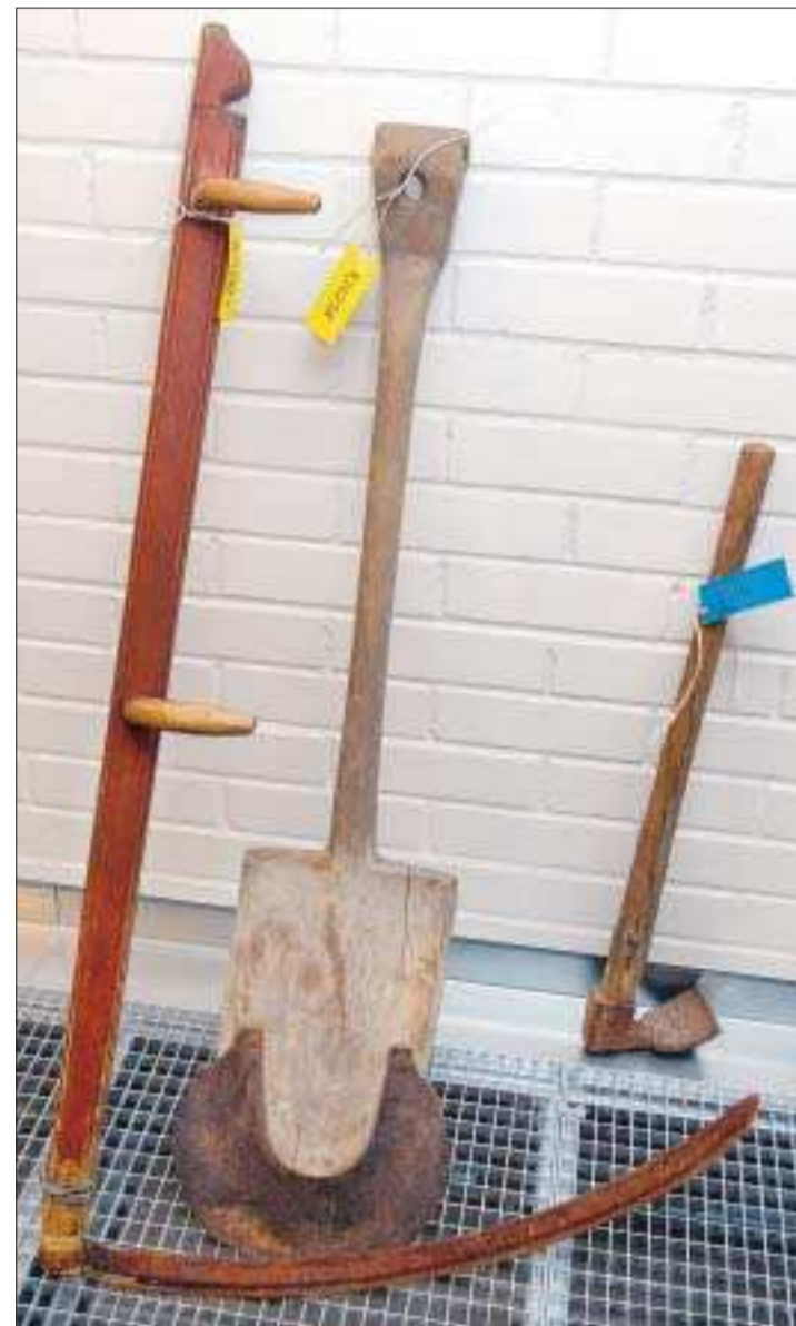
Förr. Grästrimmerns föregångare var lien (till vänster). Spaden är skodd med järn. En ekonomisk lösning då det fanns gott om trä och lite järn.
